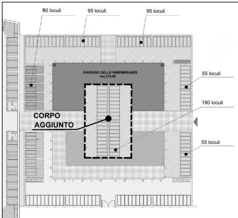
Figura 3. Ampliamento del cimitero contenuto nella *Tavola 3 "Aggiornamento"*: è stato inserito un nuovo corpo di fabbrica che potrà contenere 180 loculi. Complessivamente sarà possibile realizzare 530 sepolture.
